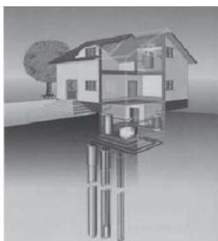
Talajkollektoros és talajszondás rendszer
