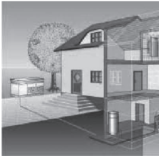
Külső levegős hőszivattyú rendszer
